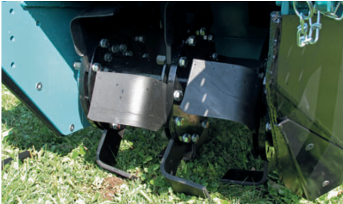
Geschl. Rotor mit Winkelmessern aus verschleißfestem Bor-Stahl
